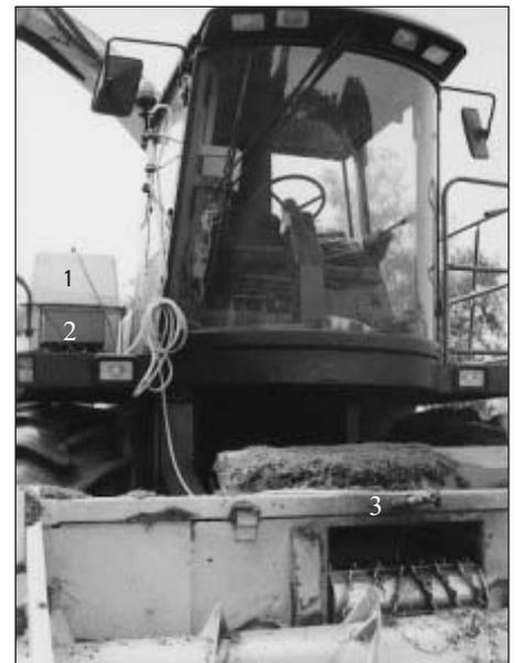
*Bild 3: Häcksler mit Vorrichtung zum Besprühen des geernteten Grases mit Starterkultur-Suspension; 1 Starterkultur-Vorratsbehälter, 2 Dosierpumpe, 3 Sprüheinrichtung*
