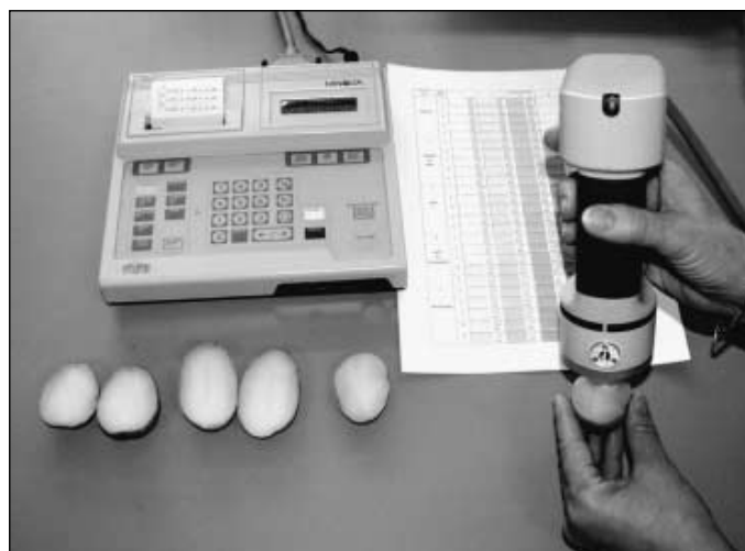
Bild 2: Bestimmung der Fleischfarbe von Kartoffeln mit dem Minolta Chroma-Meter 310
