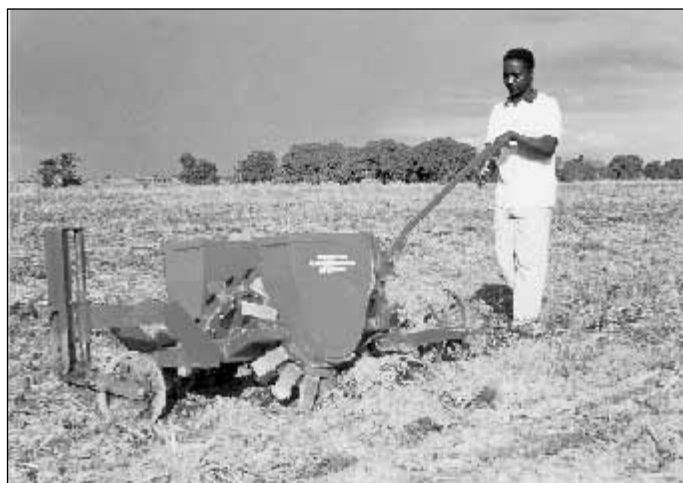
Bild 3: Einsatzsituation des in tierischer Anspannung betriebenen Spatensägerätes
