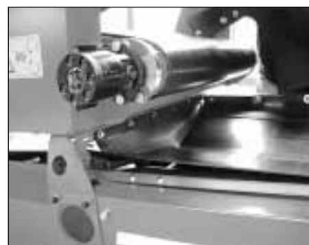
Bei den Duo-Verlängerungsbändern von Grimme sorgt ein Airbaglandungssystem für eine schonende Übergabe der Kartoffeln
