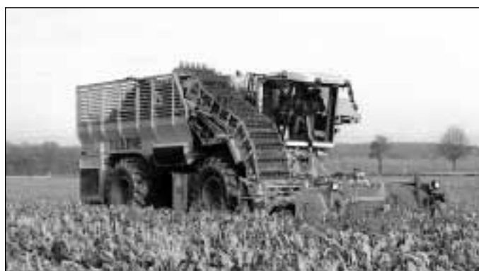
Kleine stellt den bodenschonenden Zuckerrübenroder SF 2002 vor. Aufgrund einer völlig neuartigen Konstruktion wird ein Leergewicht von nur 21,3 t realisiert bei 20 t Zuckerrübenaufnahme.
