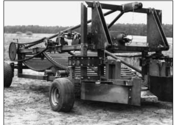
Fig. 1: Prototyp asparagus harvester
