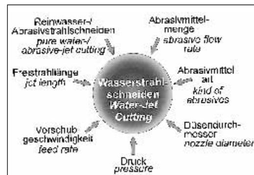
Bild 2: Verfahrensspezifische Parameter einer Wasserstrahlschneidanlage
