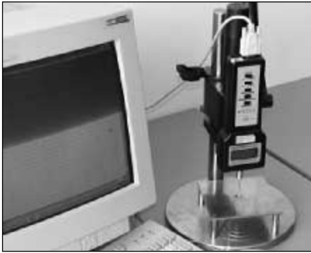
Bild 2: Digitales Penetrometer zur Bestimmung des Durchdringwiderstandes an gegarten Kartoffelscheiben
