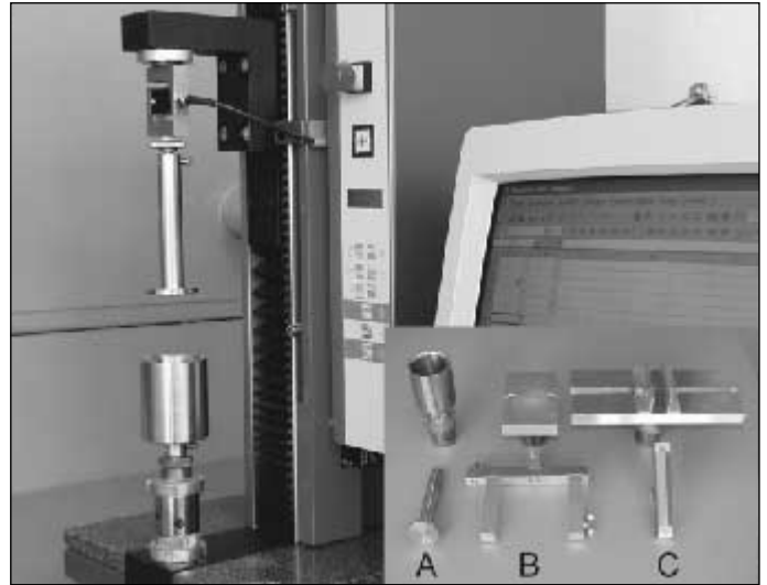
Bild 3: Materialprüfmaschine mit Werkzeugen zur Bestimmung der Extrusionskraft (A), Schneidkraft (B) und Bruchkraft (C)
