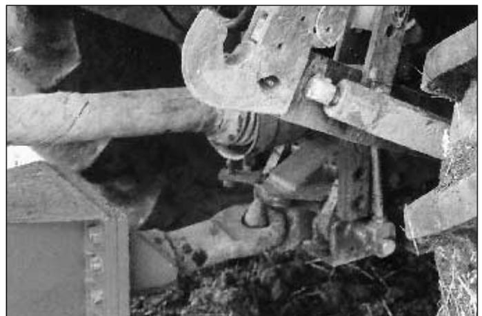
Bild 6a: Hitchanhängerkupplung an einem Standardtraktor
