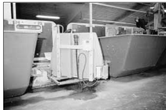
Bild 1: Einbindung der beheizten Vorratstränke in die Wiegetechnik und Datenerfassung der Anlage zur Ermittlung der Grundfutteraufnahme (Versuchsstation für Nutztierbiologie und ökologischen Landbau „Meiereihof“)
