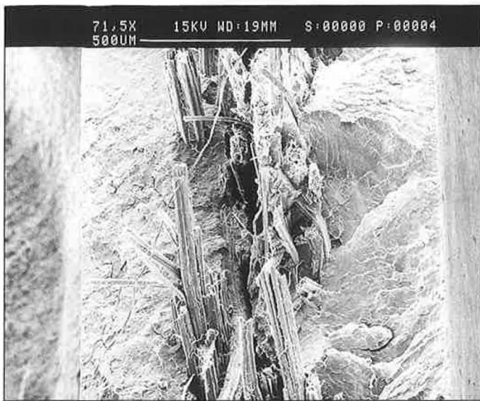
Bild 2: Schichtartiger Aufbau der Leinfasern in der PP-Matrix (Faseranteil 25%, mit Haftvermittler, Bruchstelle des Zugversuchs, 70-fache Vergrößerung)
