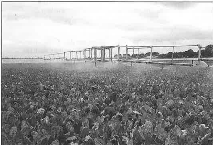
Bild 1: Mobile Beregnungsmaschine mit einem Düsenwagen zur Wasserverteilung
