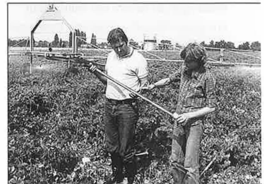
Bild 1: Mit dem Bohrstock werden Bodenproben für die gravimetrische Feuchtemessung gezogen.
