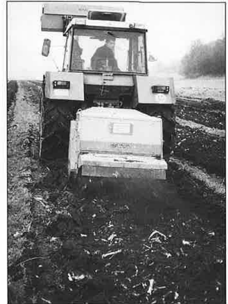
Bild 1: Rodefräse für den Umbruch von Kurzumtriebsplantagen
