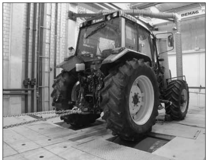
Bild 1: Versuchsfahrzeug Valmet 8050E auf dem Einachs-Rollenprüfstand
